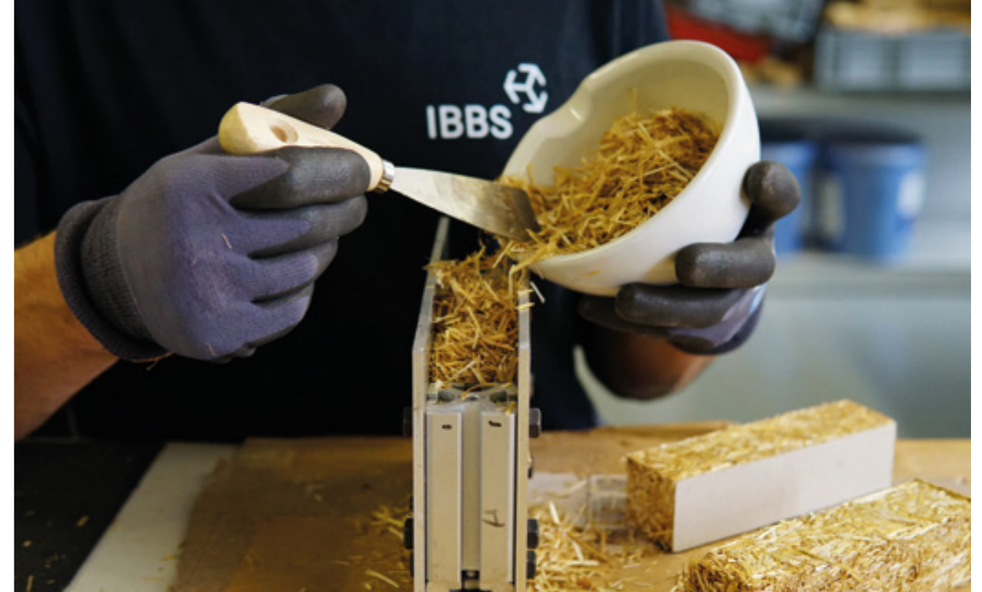
Robin Berg · Alexander Oschim Probekörper aus Stroh
